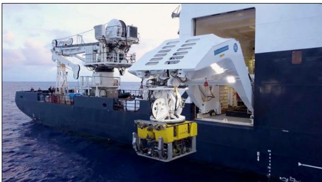
O ROV BXL79 é implantado a partir do R/V Petrel. O veículo submarino operado remotamente pode realizar missões de até 7.000 metros de profundidade. Foto gentilmente cedida por Paul G. Allen
