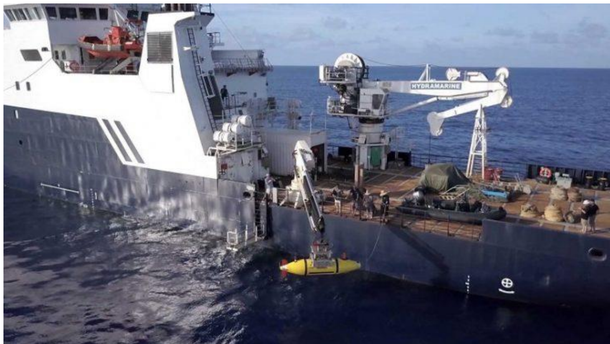
O AUV Hydroid Remus 6000 é implantado a partir do R/V Petrel . O veículo submarino autônomo é capaz de operar em até 6.000 metros de água. Foto gentilmente cedida por Paul G. Allen
